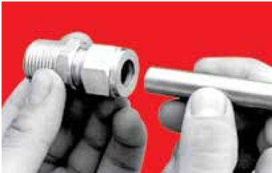
Führen Sie die Rohrleitung in die LET-LOK®-Verschraubung ein. Achten Sie darauf, dass das Rohr fest an der Verschraubungsschulter anliegt und die Mutter fingerfest angezogen ist. Es wird empfohlen, nun eine Markierung am Sechskant der Mutter bis auf den Verschraubungskörper zu ziehen. Diese Markierung dient als Kennzeichnung des Ausgangspunktes und der ordnungsgemäßen Anzugsstärke.
